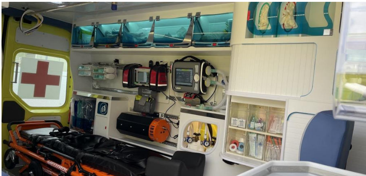
Interiér jedné ze sanitek pořízených ČČK vybavené jako mobilní JIP
